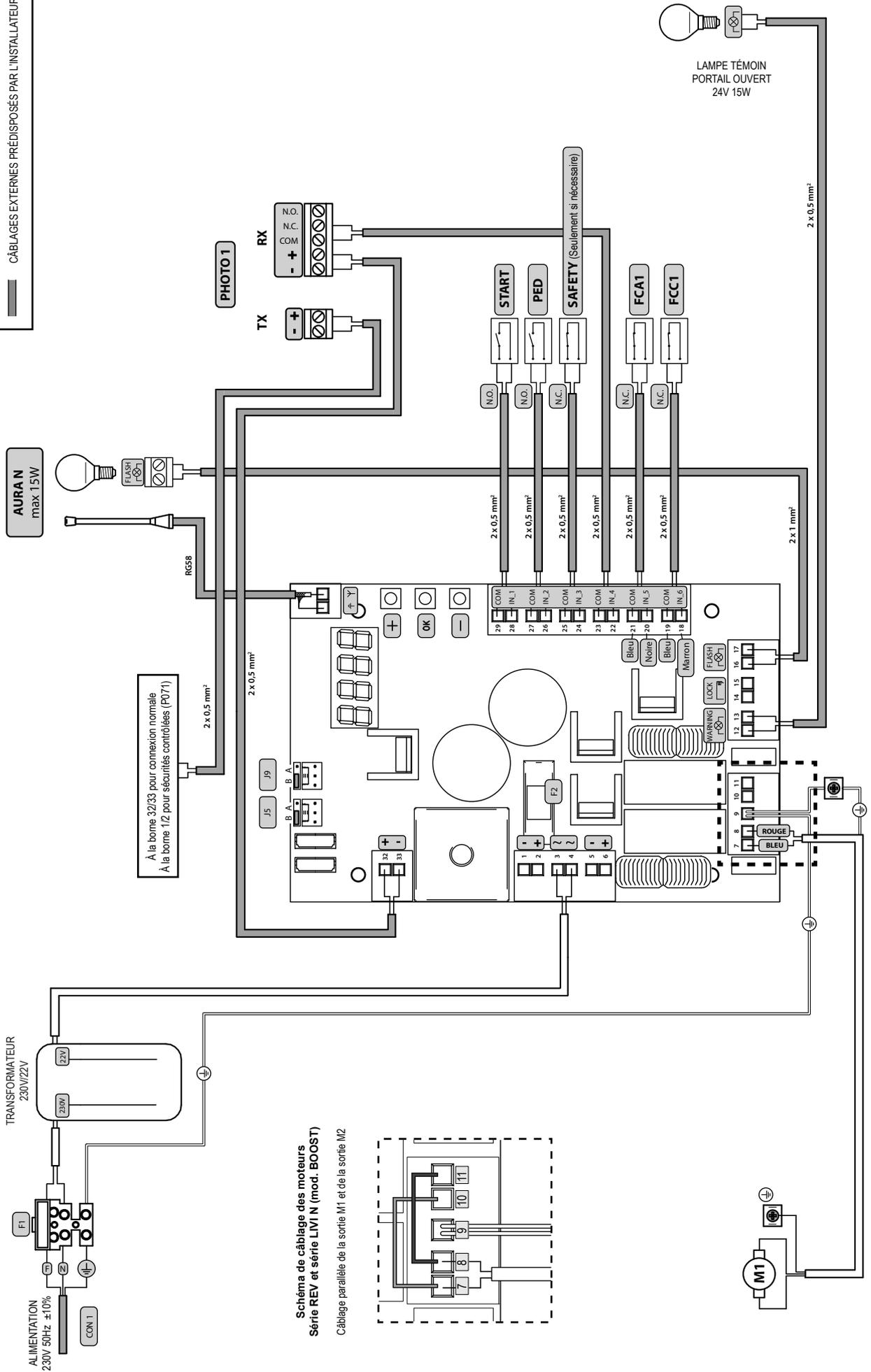
**Schéma de câblage des moteurs**
